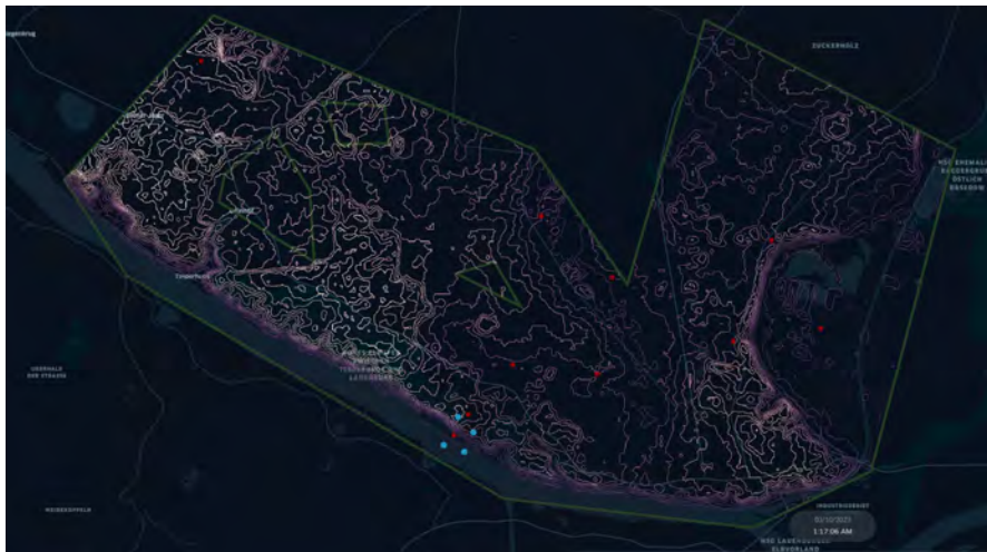
Abbildung 3.11: Visualisierung einer Simulation mit Kepler GL mit hinterlegter Höhenkarte und Hindernissen. In Rot sind die Signalquellen und in Blau die Drohnen eingezeichnet.
