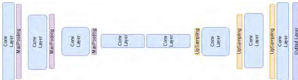
Abbildung 4.1: Visualisierung des grundlegenden Netzaufbaus, der in den Experimenten verwendet wird
